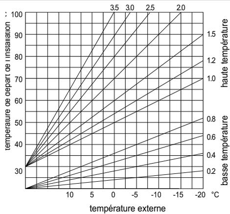
Dans le cas d'utilisation de la sonde extérieure, la chaudière calcule la température de départ la plus adaptée en tenant compte de la température extérieure et du type de l'installation.
