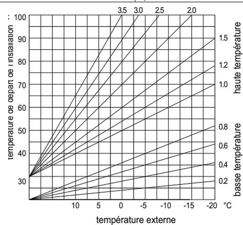
Dans le cas d'utilisation de la sonde extérieure, la chaudière calcule la température de départ la plus adaptée en tenant compte de la température extérieure et du type de l'installation.
